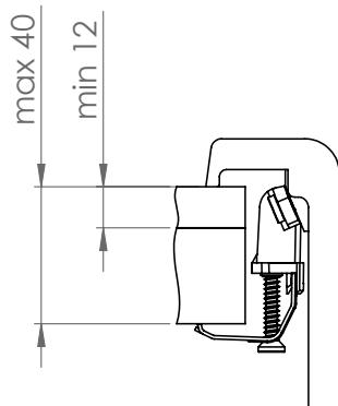
Il primo sistema al mondo che si adatta automaticamente a top con spessore da 12 a 40 mm, senza necessità di adattatori o spessori aggiuntivi. Avvitando semplicemente la vite centrale del gancio, è possibile fissare il lavello in modo rapido e preciso su un'ampia gamma di piani cucina. Una soluzione davvero universale, pensata per semplificare ogni tipo di installazione.
